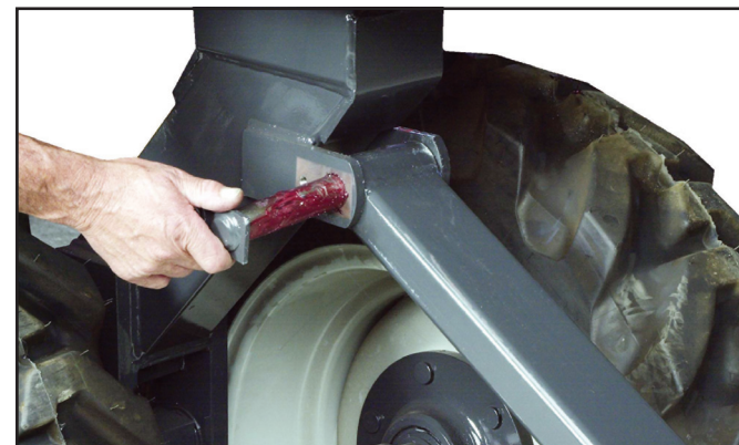
Вставьте штифт через скобу и буксирную балку и зафиксируйте его удерживающим болтом.
