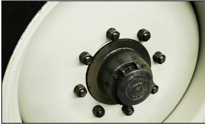
Затяните все болты колес.
