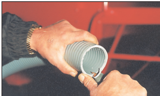
Необходимо сгладить внутренний срез шланга для более плотного соединения
