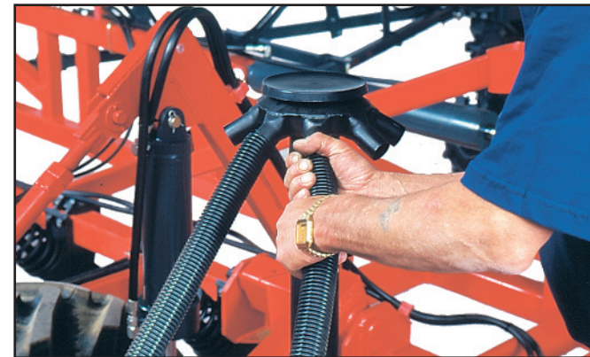
Шланги между сеятельной воронкой и раздаточной головкой необходимо как можно туго натянуть
