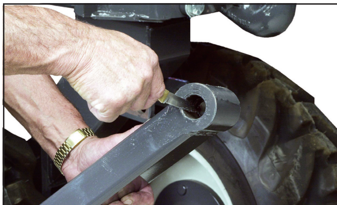
Снимите всю краску с внутренней стороны втулки жесткой буксирной балки.
