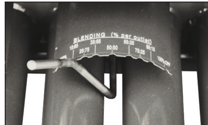
Для установки смесительных рычагов передвиньте смешивающие рычаги на передней части мерного бокса на требуемое смешивание смеси удобрение/зерно
