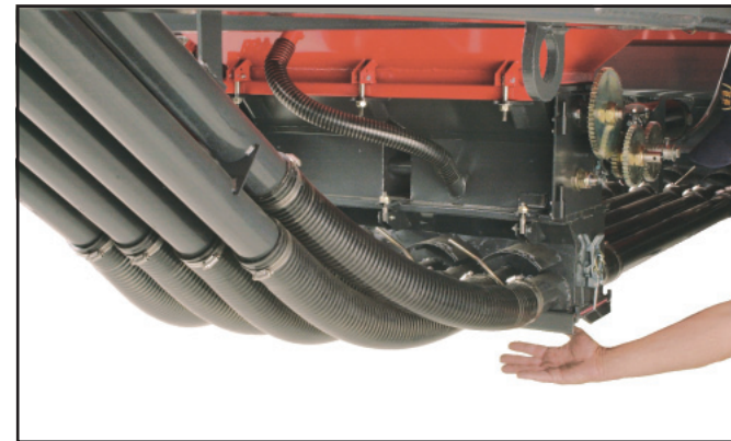
Проверьте утечки по съемным выдвижным дверцам каждой распределительной коробки.
