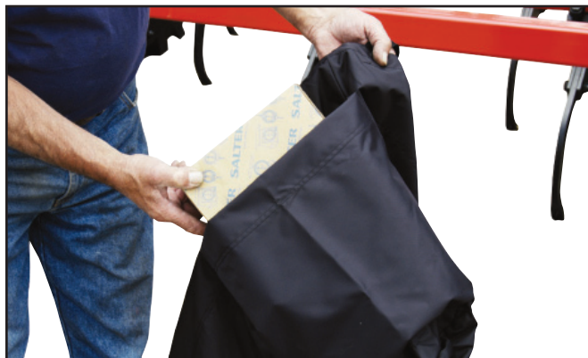
Поместите калибровочные весы в мешочек калибровочного мешка.
