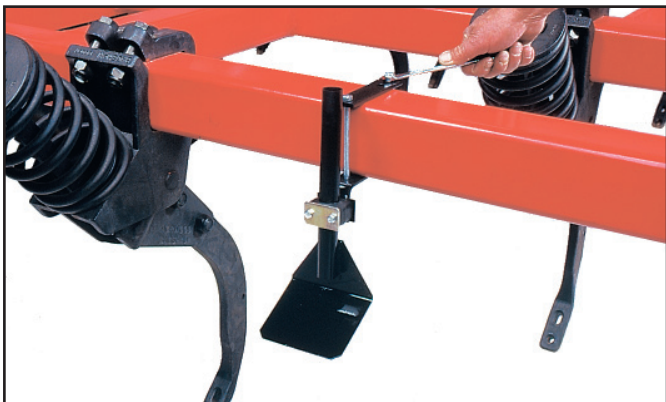
Расположите и присоедините отклоняющие пластины для мелких семян спереди или сзади балки Cultibar по желанию 600 мм.
