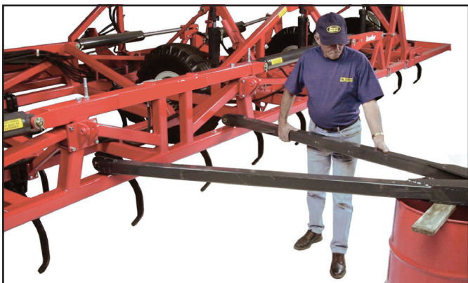
Используйте подставку для поддержки балок сцепки.
