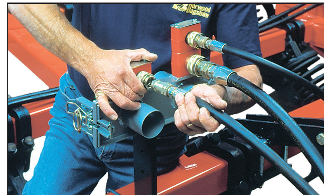
Поместите шланги над рамой сцепки сеялки и соедините их с разрывными муфтами.
