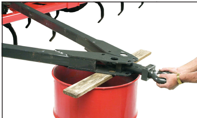
Совместите балки А-образной рамы и буксирный гак.
