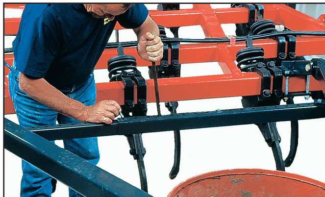
Совместите конструкцию скользящей стяжки, используя стержень для выравнивания центральных отверстий, и вставьте болты.
