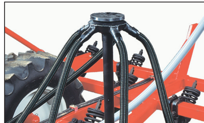
Установите шланги от раздаточных к пластинам подачи семян, натягивая их как можно туже.
