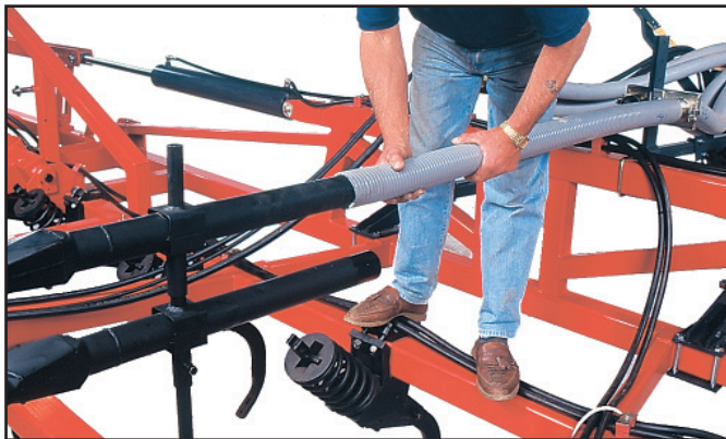
прикрепите основные шланги от разрывных муфт к Y-образным разделителям
