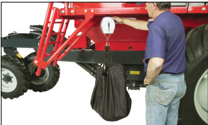
Снимите калибровочный мешок и взвесьте его на калибровочных весах
