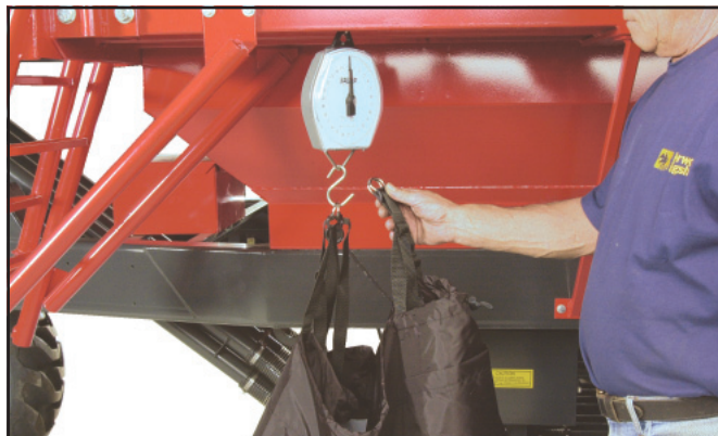
Весы и мешок для калибровки..
