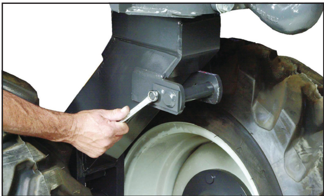
Снимите штифт, удерживающий болт.
