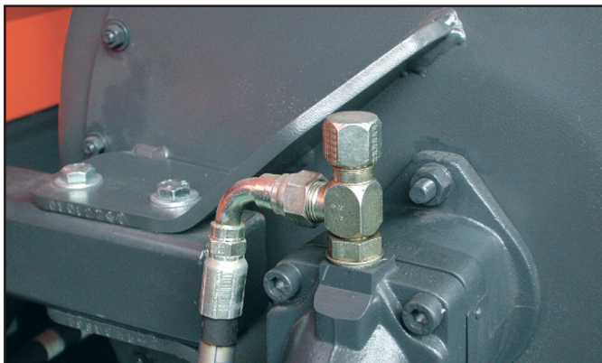
Регулярно снимайте крышку с Т-образного шланга слива 3/8" и проверяйте, заполнен ли двигатель вентилятора маслом .
