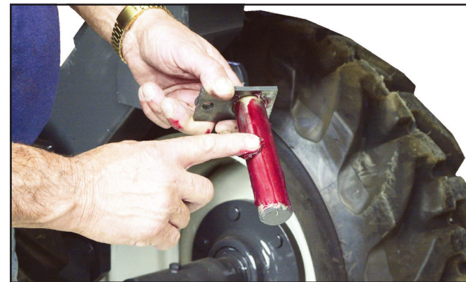
Покройте штифт слоем смазочного вещества.
