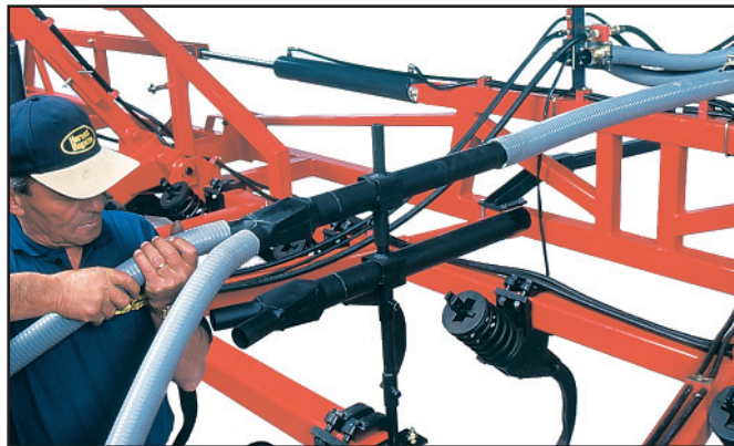
вспомогательные шланги от Y-образных разделителей присоединяются к вертикальным подающим трубкам
