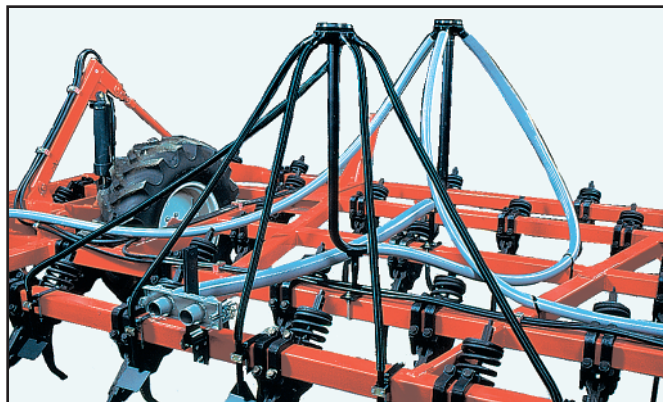
Схема распределения мелкого зерна с использованием вертикальной распределительной трубы для мелкого зерна с диам. 63,5 мм с головкой с 3 выходами
