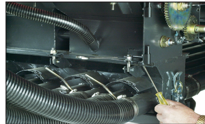
При присоединении распределительной коробки к дозирующему боксу убедитесь, что они должным образом выровнены
