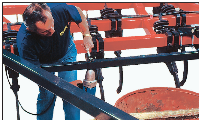
Полностью затяните все болты стяжки.
