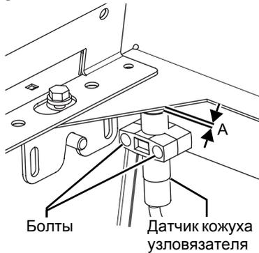
Датчик кожуха узловязателя регистрирует состояние закрытого кожуха.
