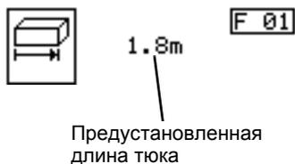
Актуальная длина тюка устанавливается механически. Система Autoform следит за длиной тюков и управляет ее с помощью электроники.
